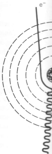
5. ábra. Az elektron és az anód atomjai közötti kölcsönhatás. Fékezési röntgensugárzás
