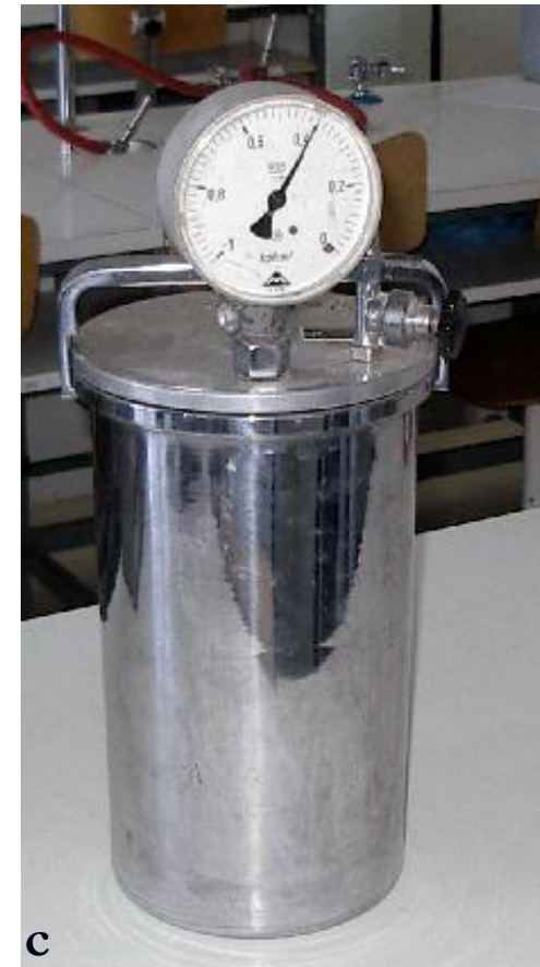
c Az anaerosztátból a levegőt eltávolítjuk (kiszívjuk), szükség esetén inert gázzal (nitrogén) feltölthetjük. A vizsgálandó anaerob baktériumokat táptalajra oltva a készülékbe helyezzük és inkubáljuk.
